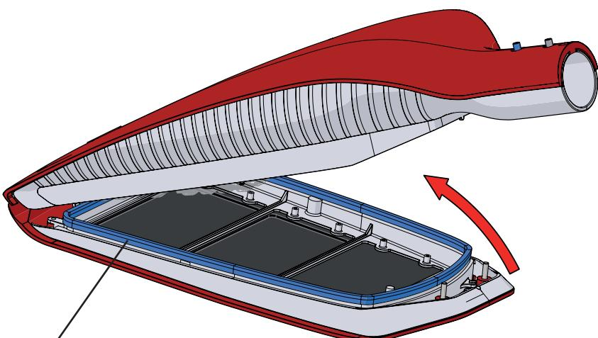
**A la fermeture, attention au positionnement du joint
