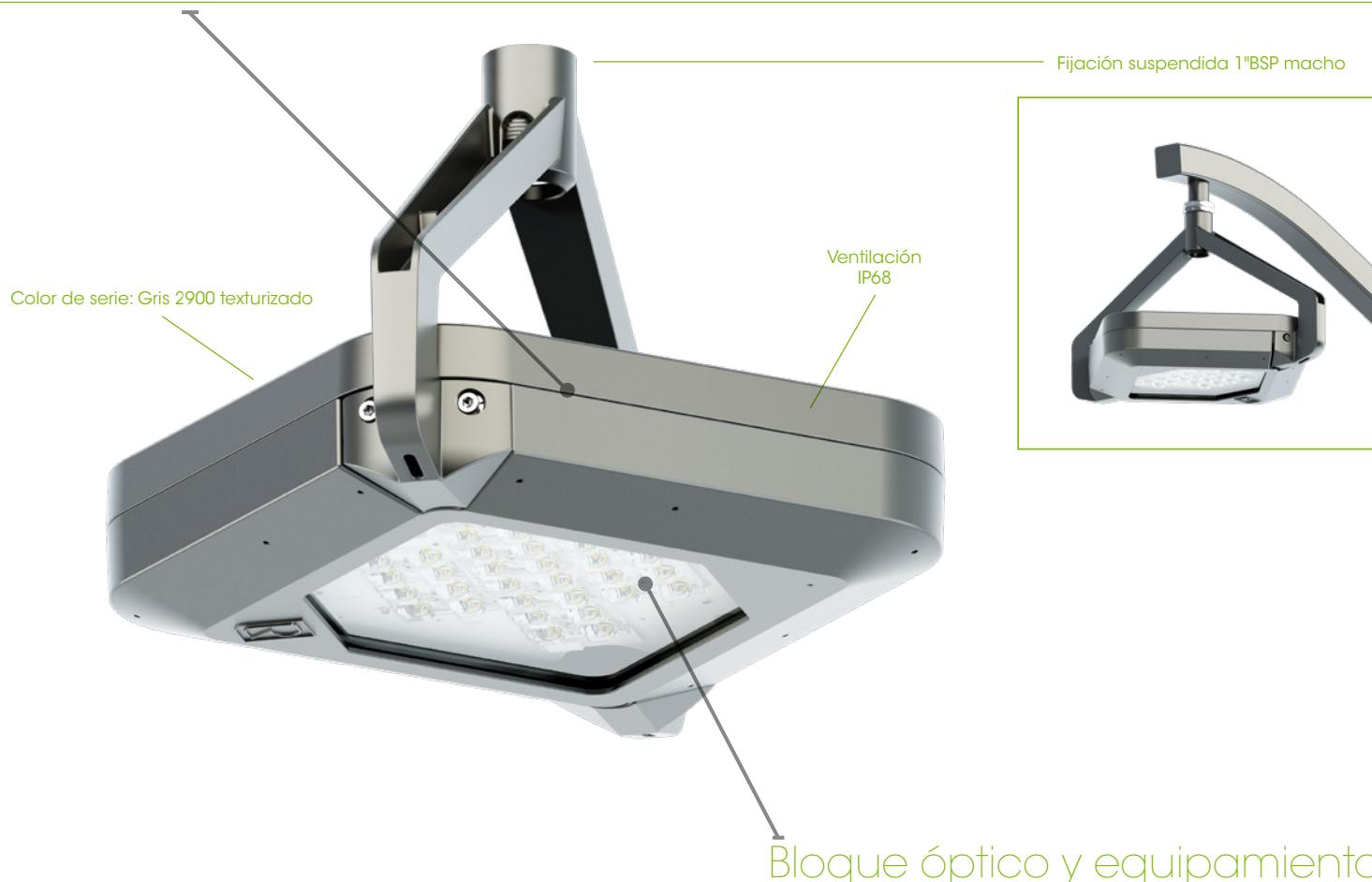
PCB con entre 12 y 32 LED - De 1800 a 8900 lm (véase la ficha técnica de Ava adjunta para una información detallada de potencia, intensidades luminosas y las fotometrías disponibles). Controlador inteligente integrado (control, atenuación automática, CLO, regulación por variación de tensión, DALI o Zhaga D4i). ULR <1 % (ULR: porcentaje de flujo luminoso dirigido directamente hacia arriba).
