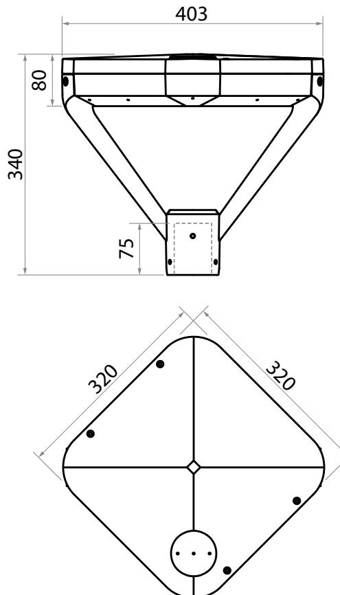
Base Zhaga en la parte superior para nodo de comunicación o fotocélula
