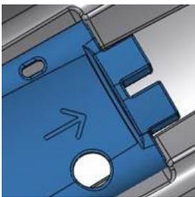
Les ergots au bout de la cale permettent son maintien en place.
